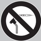
Die abgeklemmte Rohrleitung niemals durch Löten entfernen.
