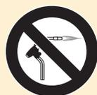
Non rimuovere MAI le tubazioni serrate mediante brasatura.
