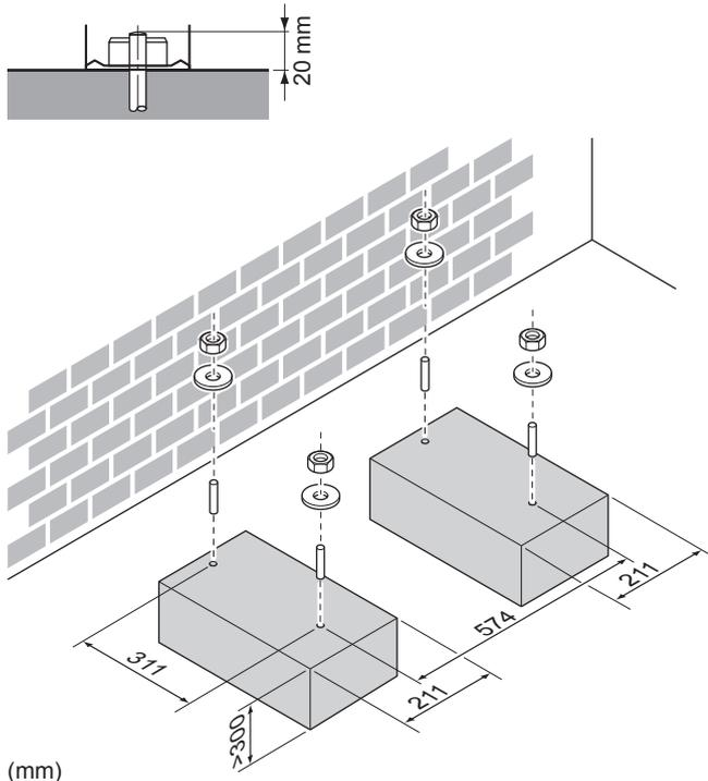
Unter der Einheit muss ein Abstand von mindestens 300 mm gelassen werden. Sorgen Sie außerdem dafür, dass die Einheit so positioniert wird, dass sie sich bei Schnee mindestens 100 mm über der maximal zu erwartenden Schneehöhe befindet. In diesem Fall wird empfohlen, die Einheit auf einem Untergestell zu bauen.
