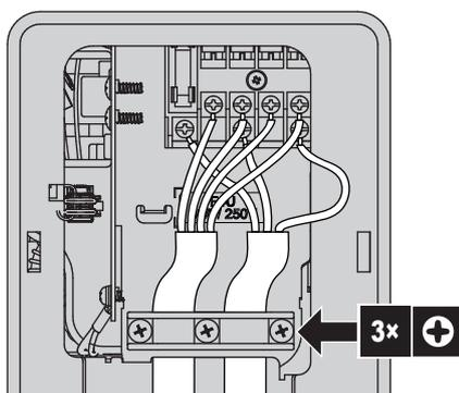
6 Ziehen Sie die Klemmschrauben fest an. Wir empfehlen die Verwendung eines Kreuzschlitzschraubendrehers.
