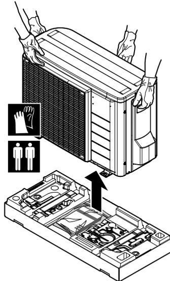
Die Einheit auf einer ebenen Fläche platzieren, um Beschädigungen zu vermeiden.
