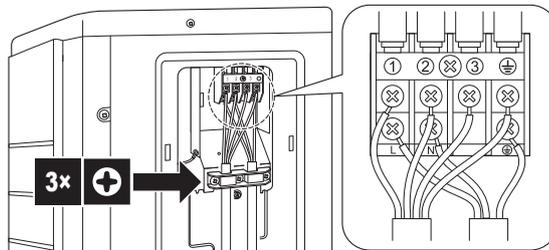
5 Ziehen Sie die Klemmschrauben fest an. Wir empfehlen die Verwendung eines Kreuzschlitzschraubendrehers.
