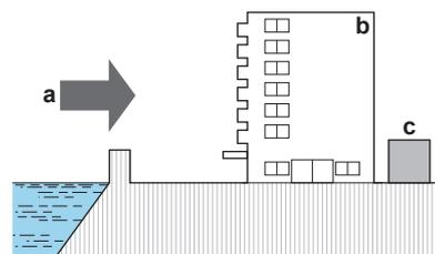
Installieren Sie eine Windschutzwand, wenn das Außengerät direktem Wind vom Meer ausgesetzt ist.
