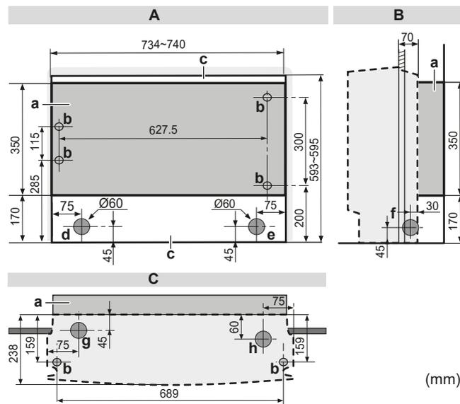
▲ 6-3 Schéma d'installation de l'unité intérieure: Installation semi-cachée
