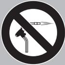
Die abgeklemmte Rohrleitung niemals durch Löten entfernen.
