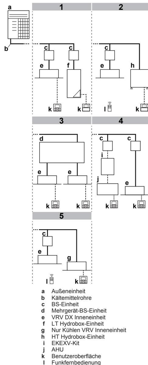
Das gesamte System kann in mehrere Subsysteme unterteilt werden. In Bezug auf die Auswahl von Kühl- oder Heizbetrieb sind diese Subsysteme 100-prozentig unabhängig voneinander, und jedes Subsystem besteht aus einer einzigen BS-Einheit oder einem einzelnen Abzweigsatz mit Mehrgerät-BS-Einheit, und alle Inneneinheiten sind in Downstream-Anordnung angeschlossen. Wird ein Kühlen/Heizen-Wahlschalter benutzt, dann schließen Sie diesen an die BS-Einheit an.
