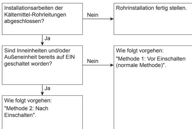
Vor Einschalten der Einheiten (außen und innen) muss die Installation der Kältemittel-Rohrleitungen unbedingt abgeschlossen sein.
