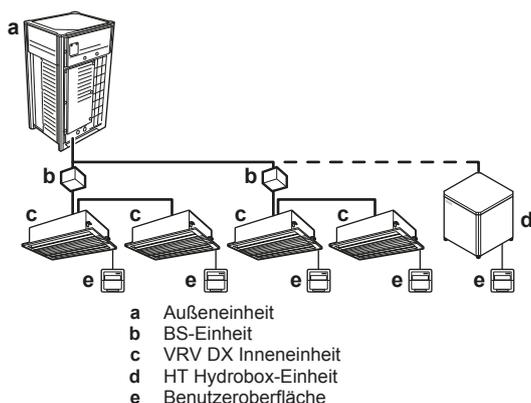
Ist das System so installiert wie in der Abbildung oben, muss – bei jedem Subsystem – eine der Benutzerschnittstellen als Master-Benutzerschnittstelle festgelegt werden.
