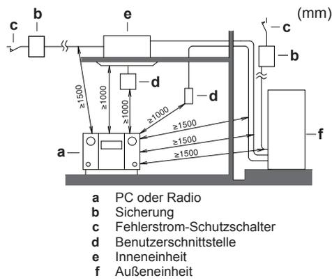
An Orten mit schwachem Empfang sollte ein Abstand von mindestens 3 m eingehalten werden, um elektromagnetische Störungen bei anderen Geräten zu vermeiden. Zum Verlegen von Strom- und Übertragungsleitungen verwenden Sie am besten Kabelkanäle.
