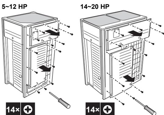
Nach Abnahme der Frontblenden kann auf den Elektroschaltkasten zugegriffen werden. Siehe "6.2.2 So öffnen Sie den Elektroschaltkasten der Außeneinheit" auf Seite 24.
