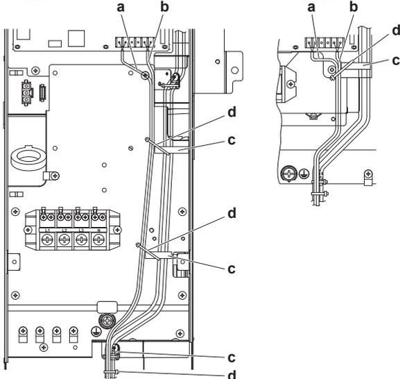
An den angezeigten Kunststoff-Halterungen mit bauseitigen Schellen befestigen.
