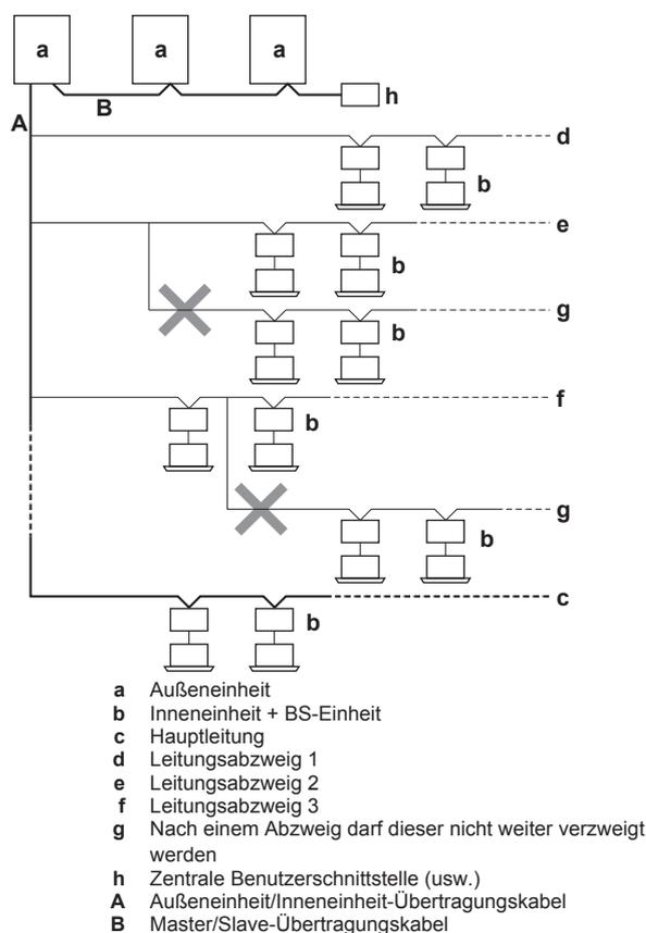
Verwenden Sie für die oben genannte Verkabelung immer Leitungen aus Vinyl mit 0,75 bis 1,25 mm<sup>2</sup> Abschirmung oder Kabel (2-adrige Kabel). (3-adrige Kabel dürfen nur für die Benutzerschnittstelle zur Kühlen/Heizen-Umschaltung verwendet werden.)
