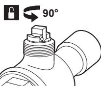
**Ergebnis:** Das Ventil ist vollständig geöffnet:
