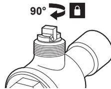
**Ergebnis:** Das Ventil ist vollständig geschlossen:
