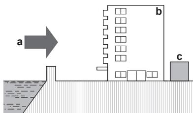
Wenn die Außeneinheit so installiert ist, dass sie Seewinden direkt ausgesetzt ist, installieren Sie einen Windschutz.
