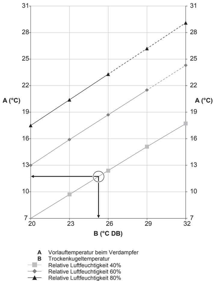
**Beispiel:** Vorgegeben sind eine Umgebungstemperatur von 25°C und eine relative Feuchtigkeit von 40%. Wenn die Vorlauf-Verdampfertemperatur <12°C beträgt, wird Kondensation auftreten.
