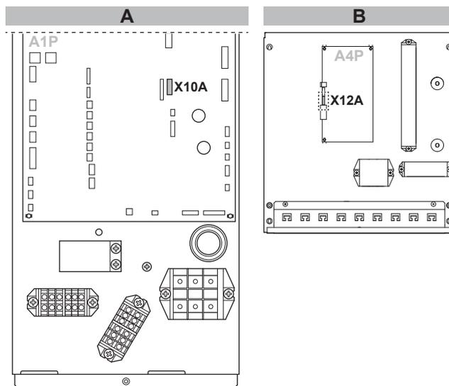
**A** Schaltkasten des Außengeräts
