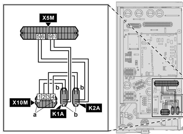
2 Schließen Sie die Niederspannungskabel wie folgt an:
