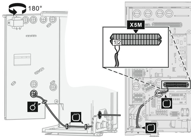
4 Fixieren Sie die Kabel mit Kabelbindern an den Kabelbinderhalterungen.
