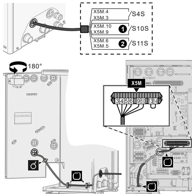
2 Fixieren Sie die Kabel mit Kabelbindern an den Kabelbinderhalterungen.
