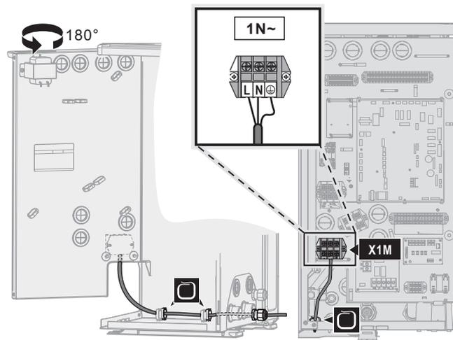
2 Schließen Sie bei Bedarf den separaten Normaltarif-Netzanschluss an.
