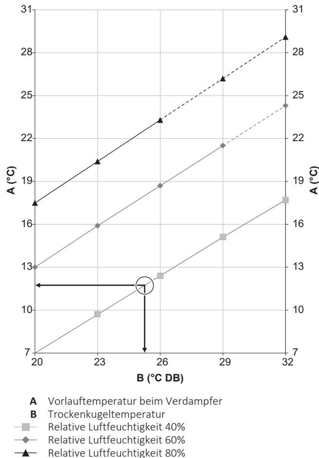
**Beispiel:** Vorgegeben sind eine Umgebungstemperatur von 25°C und eine relative Feuchtigkeit von 40%. Wenn die Vorlauf-Verdampfertemperatur <12°C beträgt, wird Kondensation auftreten.
