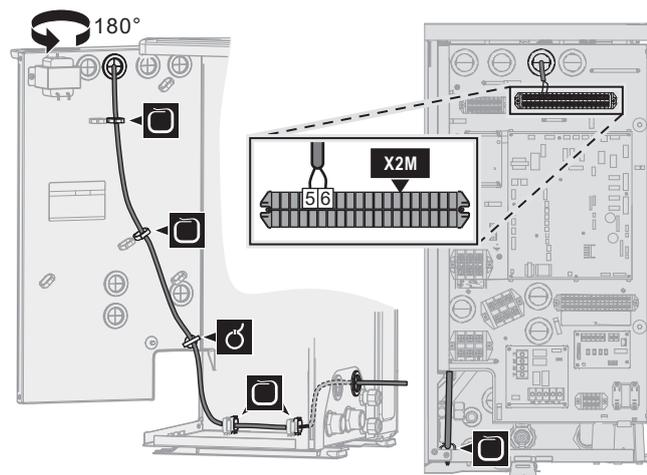
3 Schließen Sie den Kontakt für Wärmepumpentarif-Netzanschluss an.
