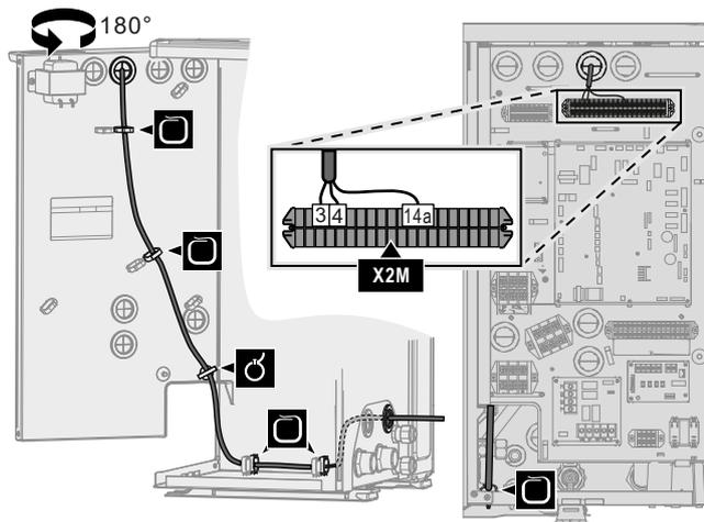
**3** Befestigen Sie das Kabel mit Kabelbindern an den Kabelbinderhalterungen.
