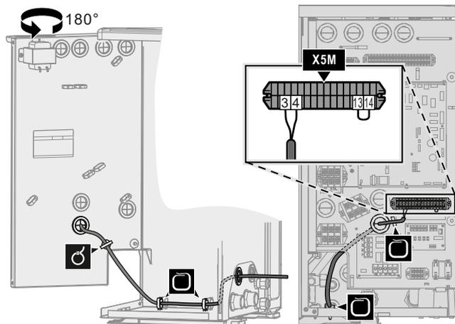
3 Schließen Sie die Hochspannungskabel wie folgt an:
