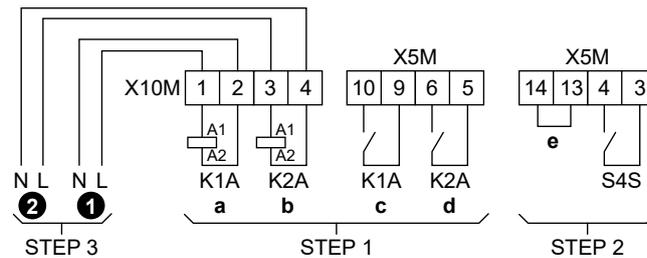
**STEP 1** Installation Smart Grid-Relaissatz
