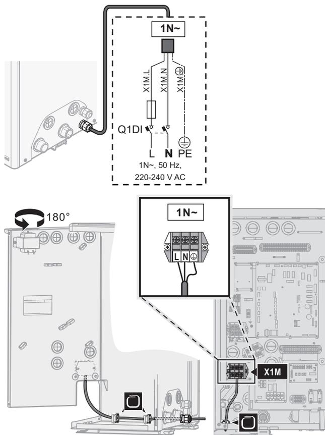
2 Fixez les câbles avec les attache-câbles sur les supports d'attaches.
