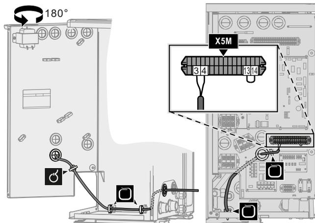
3 Raccordez le câblage haute tension de la manière suivante:
