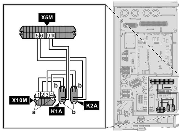
2 Raccordez le câblage basse tension de la manière suivante:
