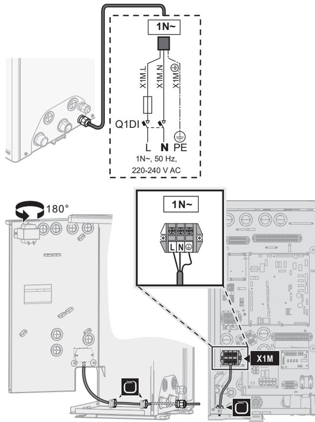
2 Si nécessaire, raccordez l'alimentation électrique à tarif normal séparée.
