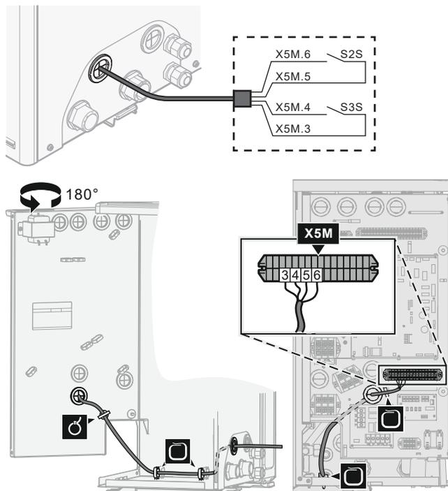
3 Fixez le câble avec les attache-câbles sur les supports d'attaches.
