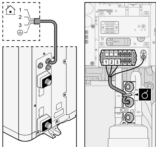
**3 (optional) Ablaufschlauchheizelement-Kabel:**
