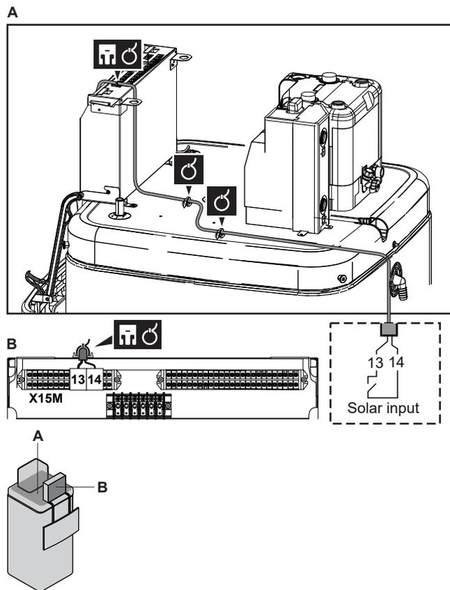
3 Befestigen Sie das Kabel mit Kabelbindern an den Kabelbinderhalterungen. Allgemeine Informationen finden Sie unter "9.3.1 Die elektrischen Leitungen an die Inneneinheiten anschließen" [▶ 122].
