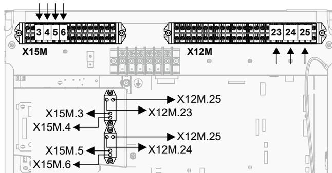
4 Schließen Sie die Niederspannungskabel wie folgt an:
