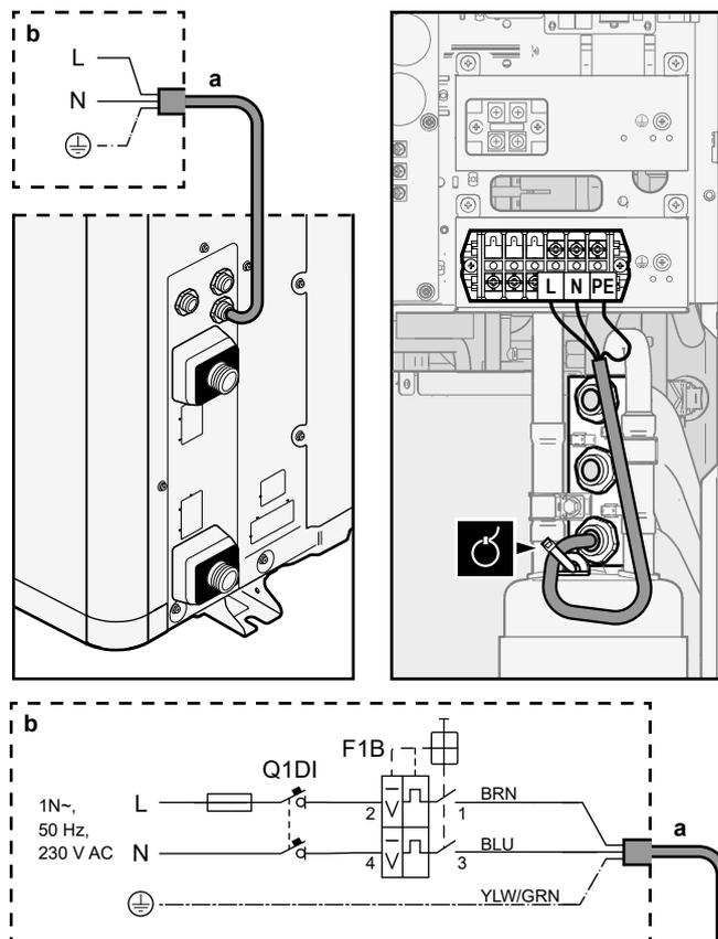
**a** Stromversorgungskabel (bauseitige Bereitstellung)
