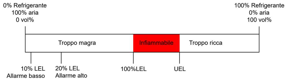
Alcuni sistemi di monitoraggio dei gas offrono limiti di allarme regolabili, ad esempio 10% e 20% o 15% e 40% del limite inferiore di esplosione (LEL).
