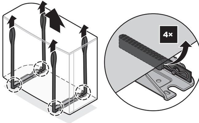
2 Montare l'unità sulla struttura di installazione.
