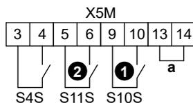
a Ponticello (montato in fabbrica). Se si collega anche il termostato di sicurezza (Q4L), occorre sostituire il ponticello con i cavi del termostato di sicurezza.
