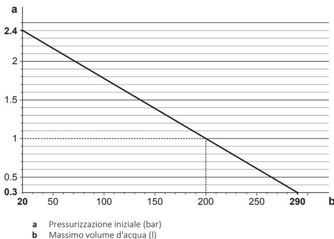
**Esempio: volume d'acqua massimo e pre-pressione del serbatoio d'espansione**
