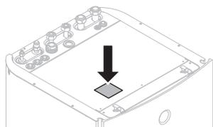
**Identification du modèle****Exemple:** E BV X 16 S 23 DJ 6V
