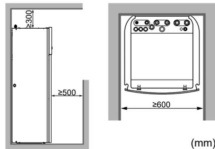
Outre les consignes d'espace : étant donné que la charge de réfrigérant totale dans le système est  $\geq 1,84$  kg, la pièce où vous installez l'unité intérieure doit également être conforme aux exigences énoncées dans la section "7.1.5 Configurations d'installation" [▶ 71].
