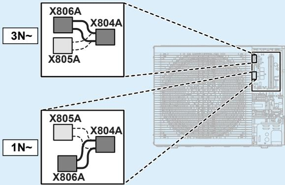
Déterminez si l'alimentation électrique de l'unité extérieure peut être interrompue (en interne par la commande de l'unité intérieure) lors de l'arrêt du fonctionnement (pas de chauffage/rafraîchissement, ni de demande en eau chaude sanitaire). L'interruption de l'alimentation de l'unité extérieure lors de l'arrêt du fonctionnement dépend au final de la température ambiante, des conditions du compresseur et des minuteries internes minimales.
