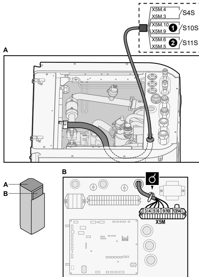
3 Fixez les câbles avec les attache-câbles sur les supports d'attaches.
