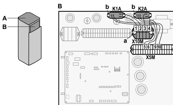
2 Raccordez le câblage basse tension de la manière suivante:
