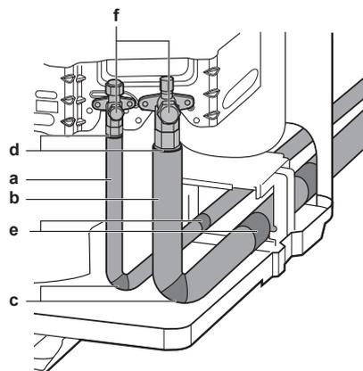
**5** Si l'unité extérieure est installée au-dessus de l'unité intérieure, recouvrez les vannes d'arrêt (f, ci-dessus) avec du matériel d'étanchéité afin d'empêcher que l'eau de condensation qui se trouve sur les vannes d'arrêt ne pénètre dans l'unité intérieure.
