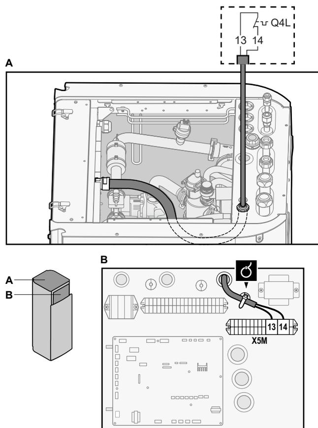
3 Fixez le câble avec les attache-câbles sur les supports d'attaches.
