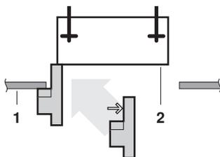
Bei Installationen mit **selbstreinigender Zierblende** nach Entfernen des Abreiß-Streifens die lange Seite der Installationsanleitung anwenden.
