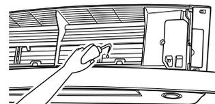
3) Verwenden Sie zur Verlängerung des Ablaufschlauchs einen handelsüblichen Verlängerungsschlauch mit einem Innendurchmesser von 16 mm. Isolieren Sie den im Innenbereich verlaufenden Teil des Verlängerungsschlauchs ordnungsgemäß.
