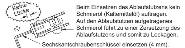
Beim Einsetzen des Ablaufstutzens kein Schmieröl (Kältemittelöl) auftragen. Auf den Ablaufstutzen aufgetragenes Schmieröl führt zu einer Zersetzung des Ablaufstutzens und somit zu Leckagen.
