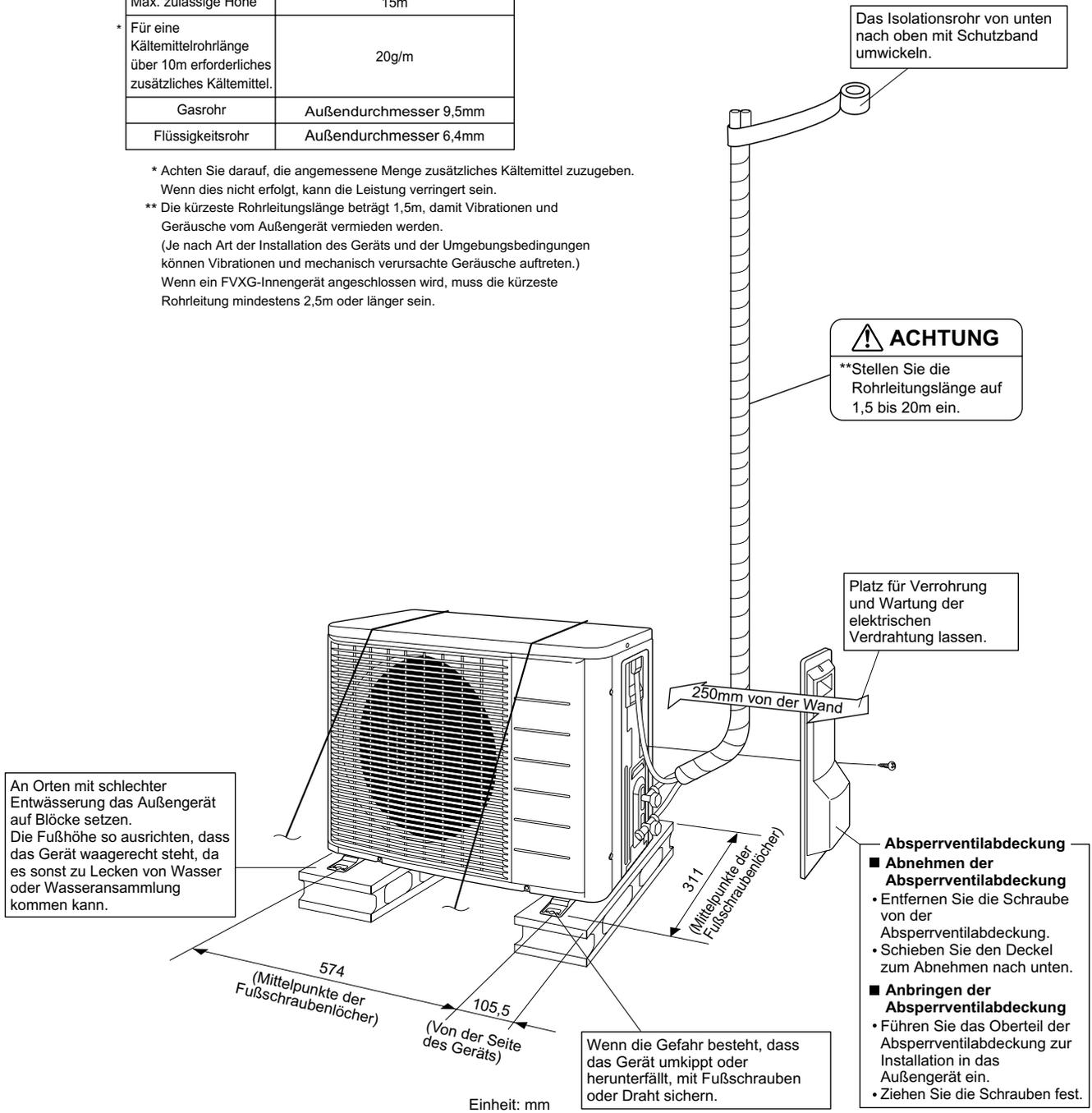
Das Isolationsrohr von unten nach oben mit Schutzband umwickeln.
