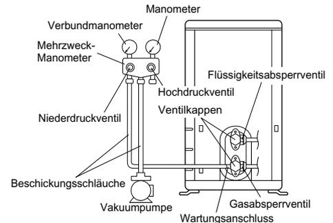
1) Den vorstehenden Teil des Füllschlauchs (am Mehrzweck-Manometer angeschlossen) an den Wartungsanschluss des Gasabsperrentils anschließen.
