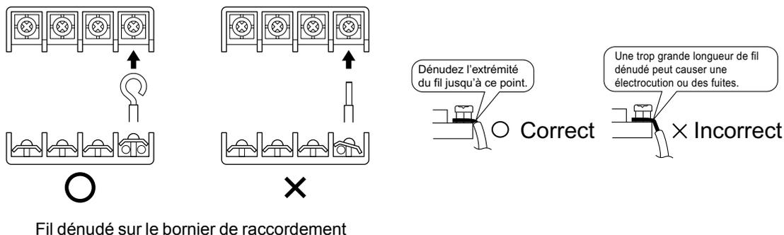
Fil dénudé sur le bornier de raccordement
