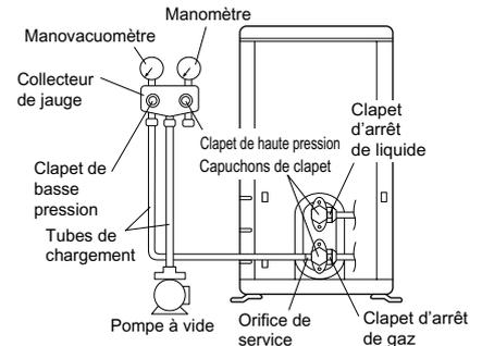
1) Connectez le côté saillant du tube de charge (provenant du collecteur de jauge) pour fermer l'orifice de service du clapet d'arrêt de gaz.
