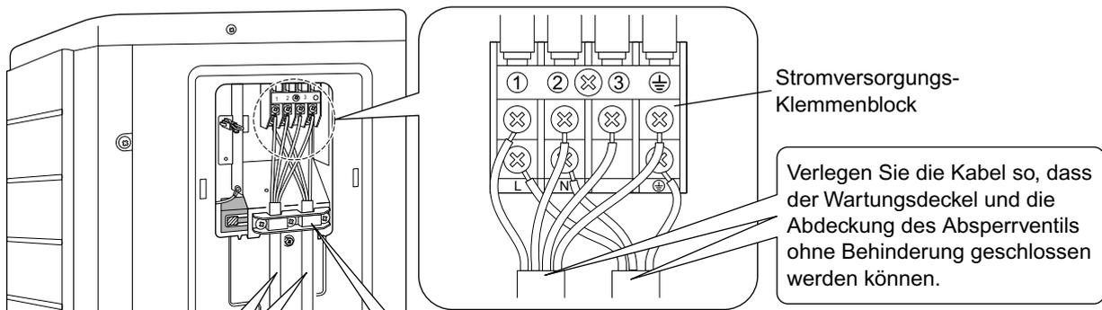
Verwenden Sie den vorgeschriebenen Drahttyp, und schließen Sie diesen sicher an.
