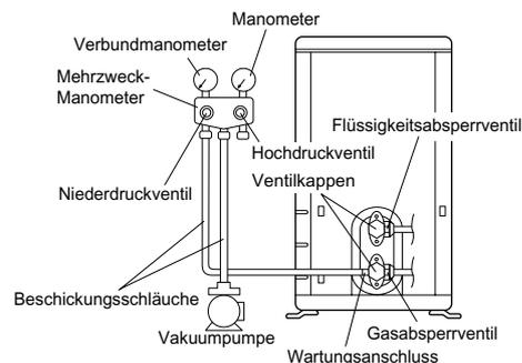
1) Den vorstehenden Teil des Füllschlauchs (am Mehrzweck-Manometer angeschlossen) an den Wartungsanschluss des Gasabsperrentils anschließen.
