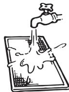
Quando il filtro dell'aria è molto sporco, usare una spazzola morbida e un detergente neutro. Rimuovere l'acqua e asciugare all'ombra.
