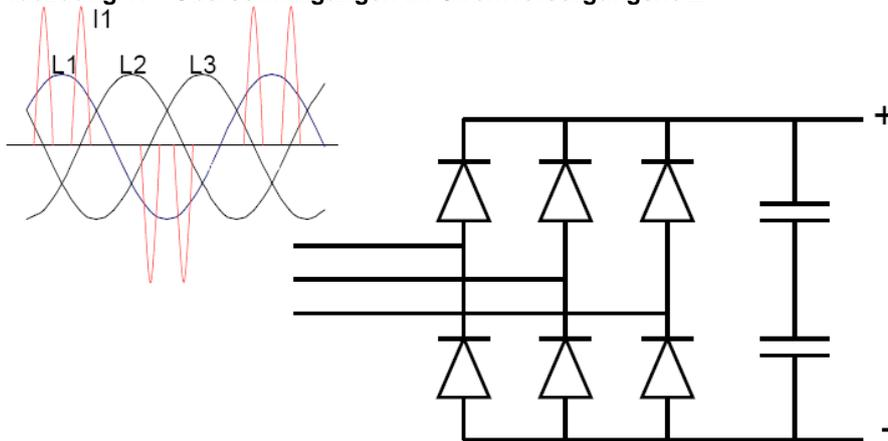
Da der Brückgleichrichter einen Gleichstromphase vor sich sieht, wird der Strom praktisch in Phase mit der Spannung aufgenommen. Dennoch gilt die unten stehende Formel nicht mehr:
