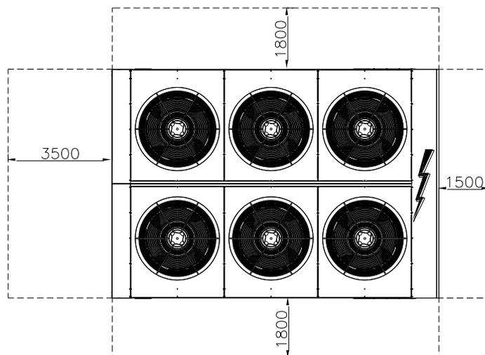
**Abbildung 4 - Erforderliche Mindestabstände für Wartungsarbeiten an der Maschine**
