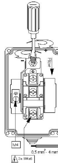
**Abbildung 8 - Strömungsschalter einstellen**
