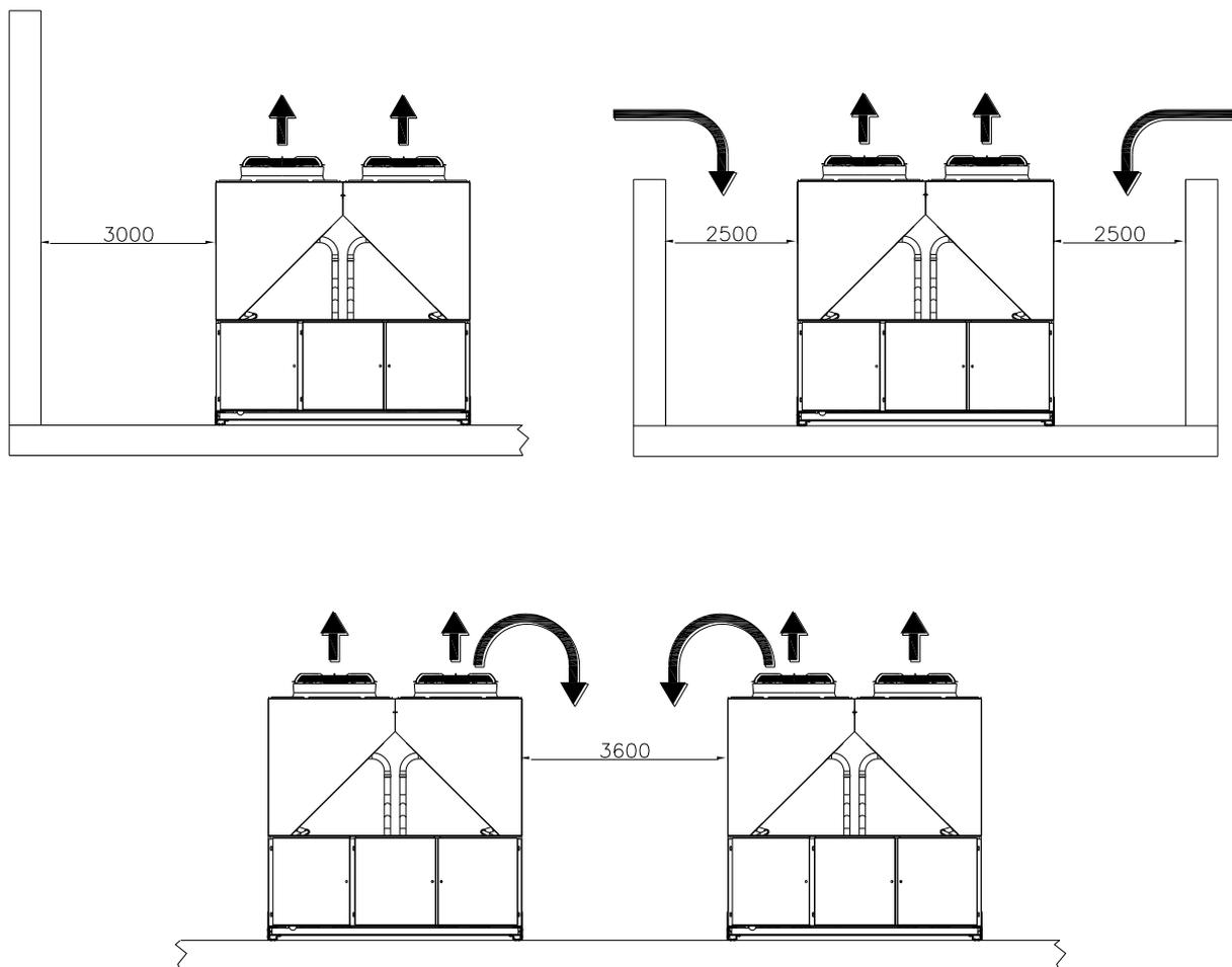
**Abbildung 5 - Empfohlene Mindestzwischenräume bei der Installation**
