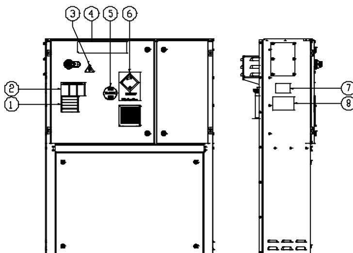
Fig. 22 - Descrizione delle etichette applicate sul quadro elettrico di EWYTx5B
