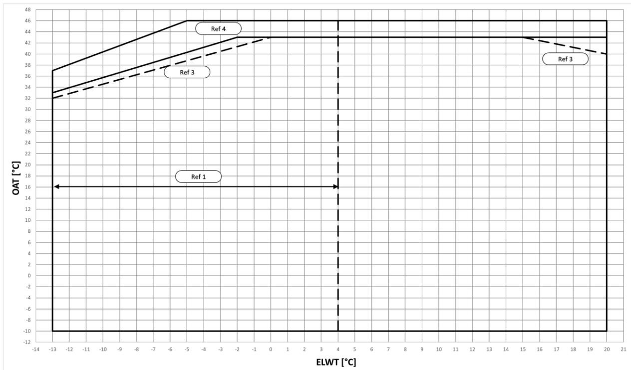
Fig. 1 - Limiti operativi della modalità di raffreddamento di EWYTxx5B-S
