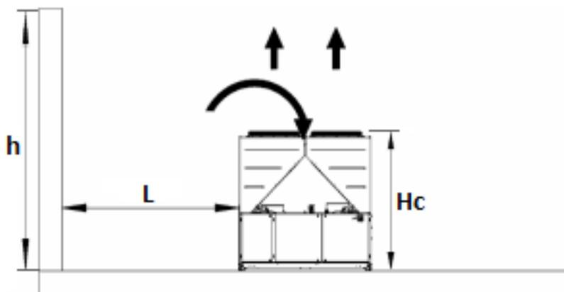
Se  $h < H_c \rightarrow L \geq 3,0$  m (V multipla) /  $L \geq 1,8$  m (V singola); se  $h > H_c$  o se L è minore del valore raccomandato, contattare il distributore Daikin per valutare le possibili soluzioni.
