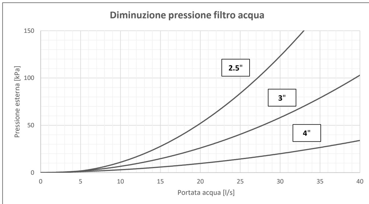
Fig. 13 - Calo di pressione del filtro dell'acqua
