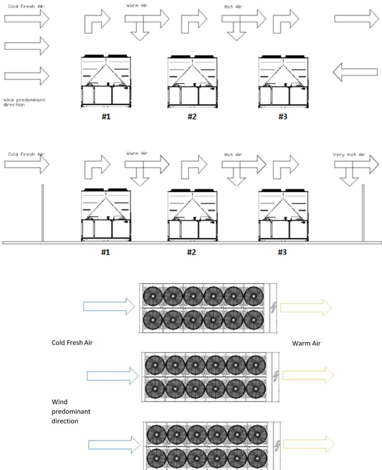
**Fig. 12 - Installazione di più unità (modalità di raffreddamento)**
