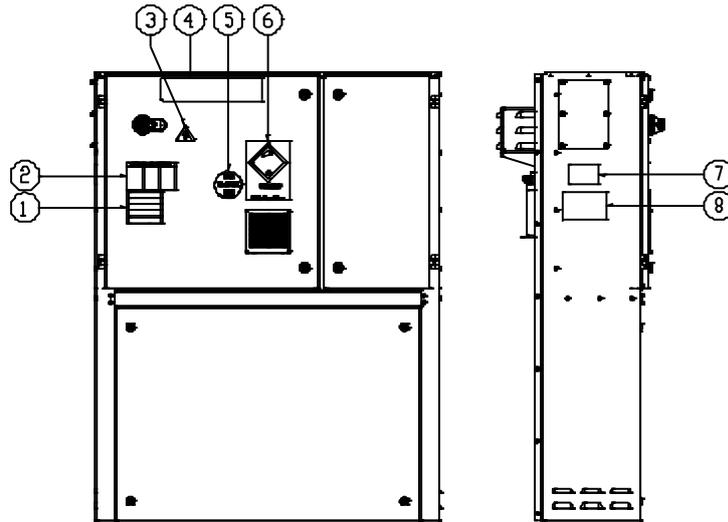
Fig. 20 - Descrizione etichette applicate su quadro elettrico EWYTx5B
