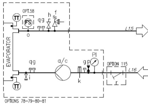
Fig. 7 - Schema idraulico per pompa singola / gemellare (EWYTx5B) (opz. 78-79/134-135) (pressione massima operativa 6 bar)
