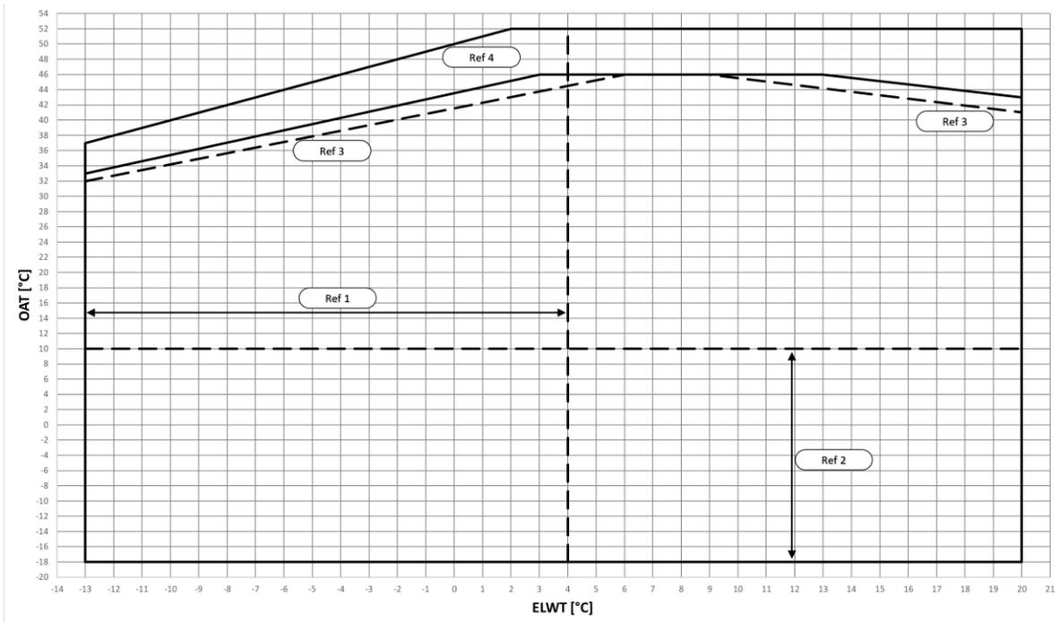
**Fig. 13 - Limiti Operativi EWTxx0B-S in Modalità Raffrescamento**
