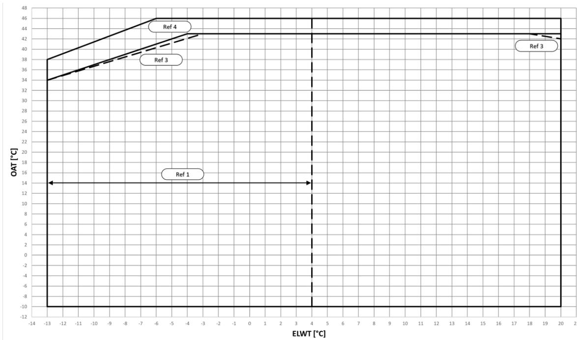
**Fig. 12 - Limiti Operativi EWYTx5B-X in Modalità Raffrescamento**
