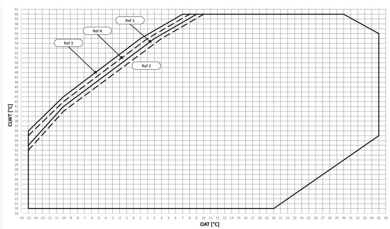
**Fig. 15 - Limiti Operativi EWYT-B-S in Modalità Riscaldamento**
