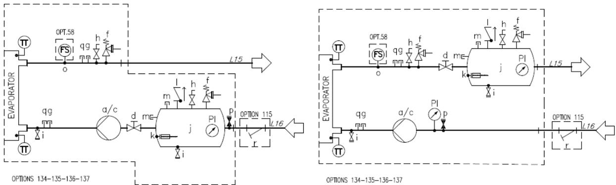
Fig. 8 - Schema idraulico per pompa singola / gemellare con serbatoio (EWYTx5B) (opz. 78-79/134-135) (pressione massima operativa 6 bar)
