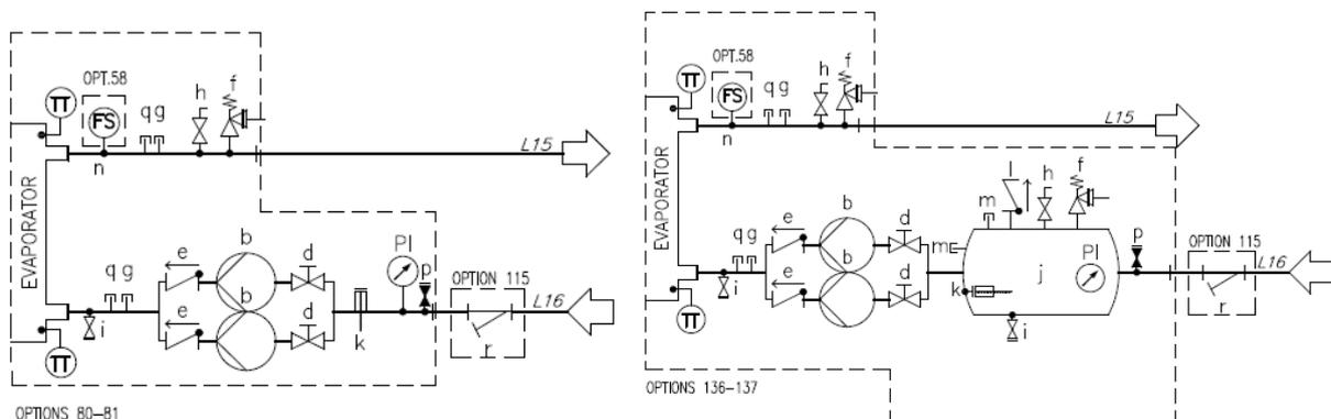
Fig. 9 - Schema idraulico per pompa doppia (EWYTx5B) (opz. 80-81/136-137) (pressione massima operativa 6 bar)
