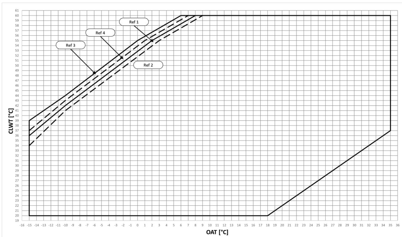
**Fig. 16 - Limiti Operativi EWYT-B-X in Modalità Riscaldamento**
