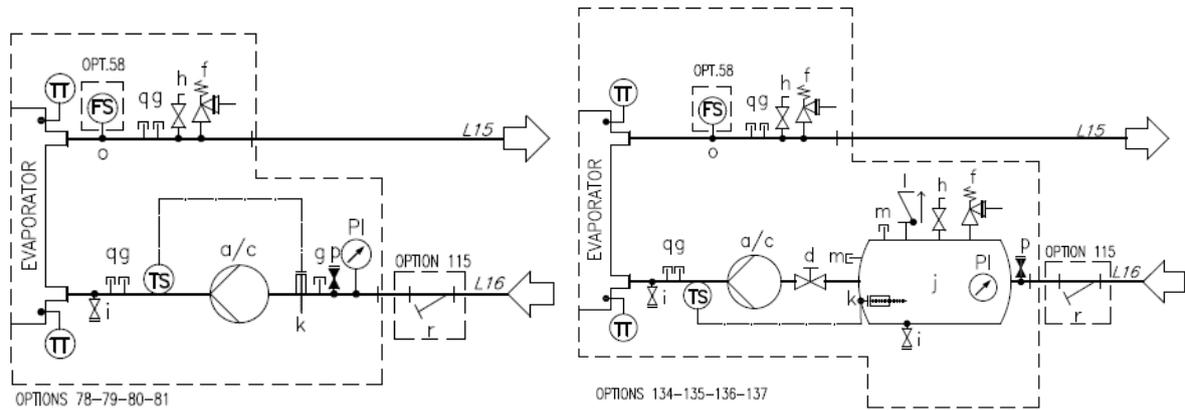
**Fig. 10 - Schema idraulico per pompa singola / gemellare (EWYTx0B) (opz. 78-79-80-81/134-135-136-137) (pressione massima operativa 6 bar)**
