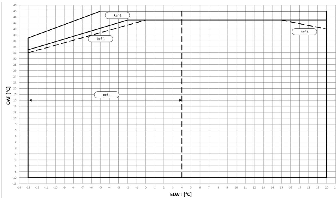
**Fig. 11 - Limiti Operativi EWYTx5B-S in Modalità Raffrescamento**
