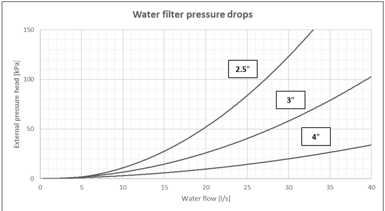
Fig. 5 - Perdite di carico filtro dell'acqua
