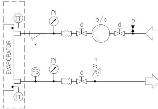
Fig. 6 - Schema idraulico senza pompa/e a bordo (pressione massima operativa 20 bar)
