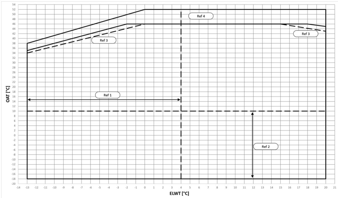
**Fig. 14 - Limiti Operativi EWTxx0B-X in Modalità Raffrescamento**
