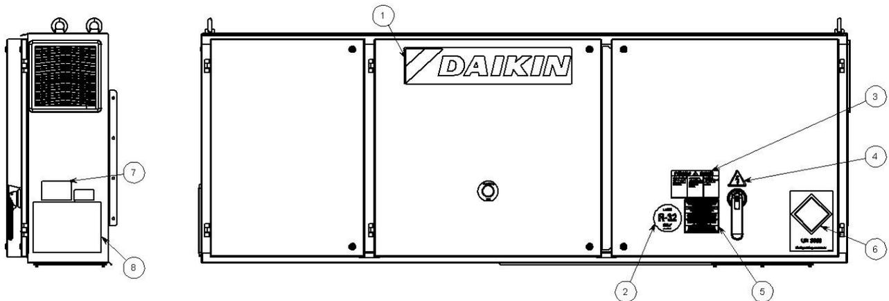
Fig. 21 - Descrizione etichette applicate su quadro elettrico EWYTx0B
