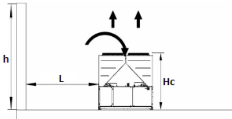
Se  $h < H_c \rightarrow L \geq 3,0$  m (multi V) /  $L \geq 1,8$  m (parallel coil); se  $h > H_c$  o  $L$  è minore del valore raccomandato, contattare il vostro distributore Daikin per valutare le diverse modalità possibili.
