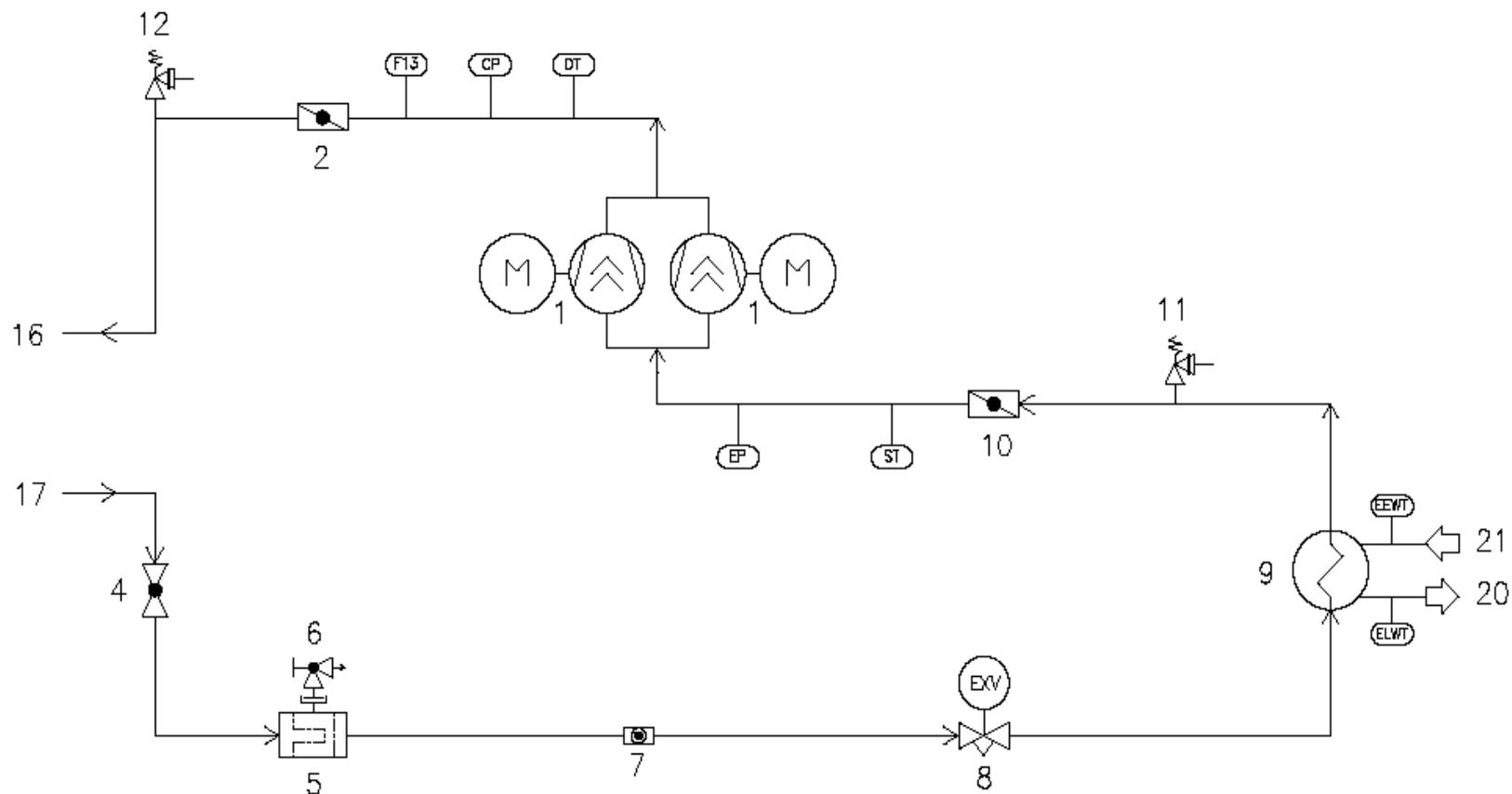
**Figure C - Circuit type avec un seul réfrigérant de la version pompe à chaleur**
