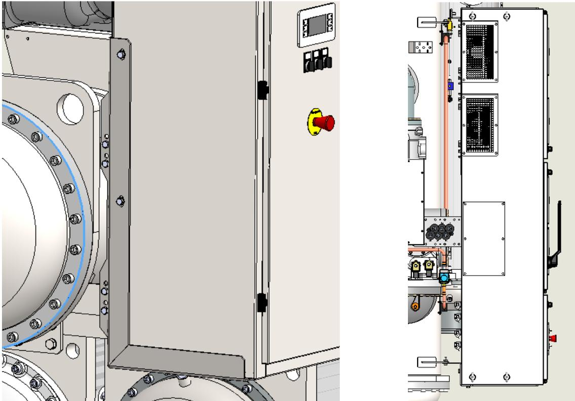
Große Schalttafel: In diesem Fall wird die Schalttafel zuerst auf dem Geräterahmen positioniert, dann muss sie mit den im Lieferumfang des Geräts enthaltenen Schrauben über die Montagewinkel (siehe Abbildung unten) an das Gerät auf der Verdampferseite geschraubt werden.
