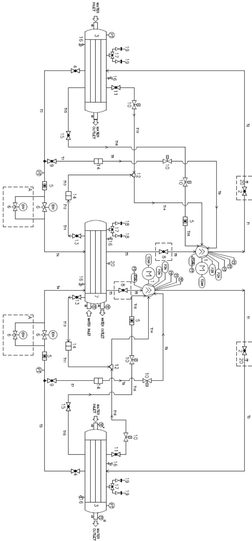
Abbildung17 - Typischer Doppelkreis-Kühlkreislauf
