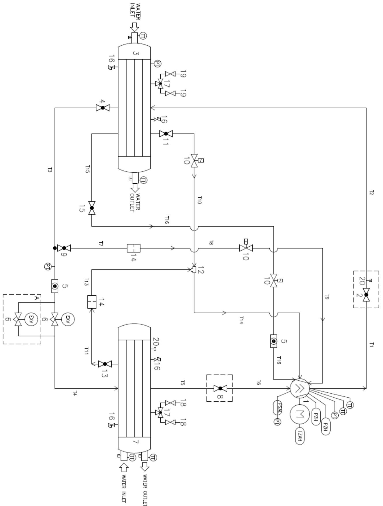
Abbildung16 - Typischer Einzelkreis-Kühlkreislauf
