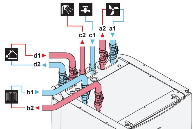
a1 WASSEREINLASS für Raumheizungs-Zusatz-/direkte Zone (Schraubverbindung, 1")
