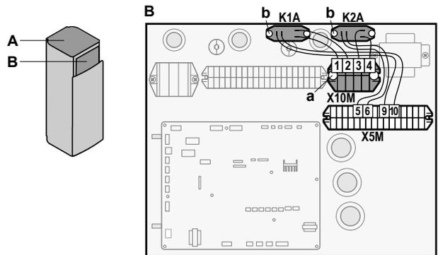
3 Fixieren Sie die Kabel mit Kabelbindern an den Kabelbinderhalterungen.
