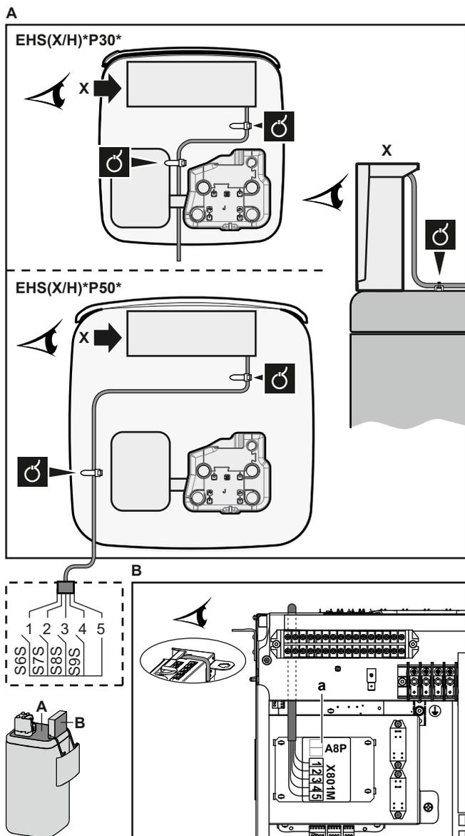
4 Fissare il cavo agli appositi supporti utilizzando le fascette. Per le informazioni generali, vedere "6.3.1 Collegamento del cablaggio elettrico all'unità interna" [p 20].
