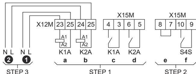
STEP 1 Installazione del kit relè della Smart Grid
