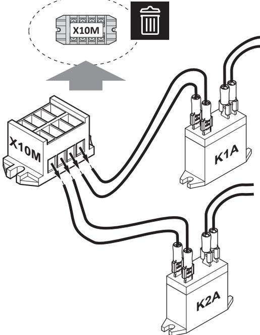
3 Installare i componenti del kit relè della Smart Grid nel modo seguente:
