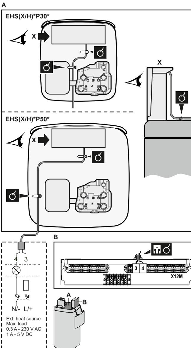
3 Fissare il cavo agli appositi supporti utilizzando le fascette. Per le informazioni generali, vedere "6.3.1 Collegamento del cablaggio elettrico all'unità interna" ► 20].
