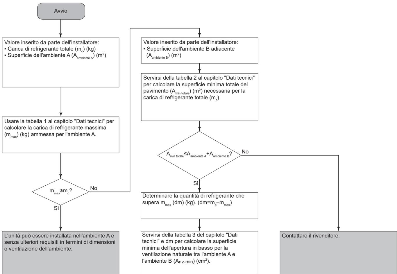
L'unità può essere installata **nell'ambiente A** a condizione di prevedere 2 aperture (una in basso, una in alto) tra l'ambiente A e B per assicurare la ventilazione naturale. Le aperture devono rispettare le condizioni seguenti:
