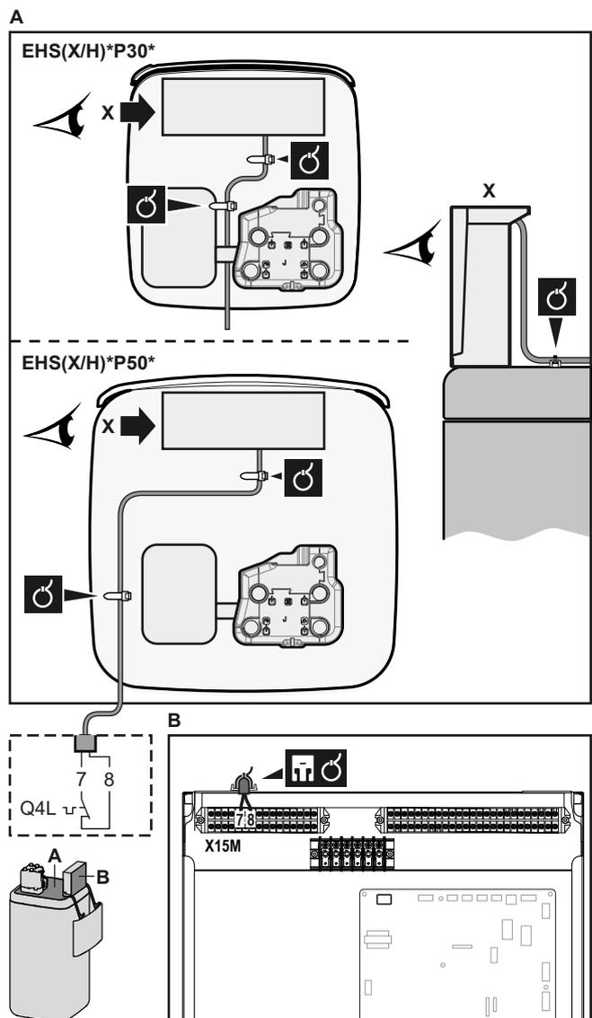
3 Fissare il cavo agli appositi supporti utilizzando le fascette. Per le informazioni generali, vedere "6.3.1 Collegamento del cablaggio elettrico all'unità interna" [p 20].
