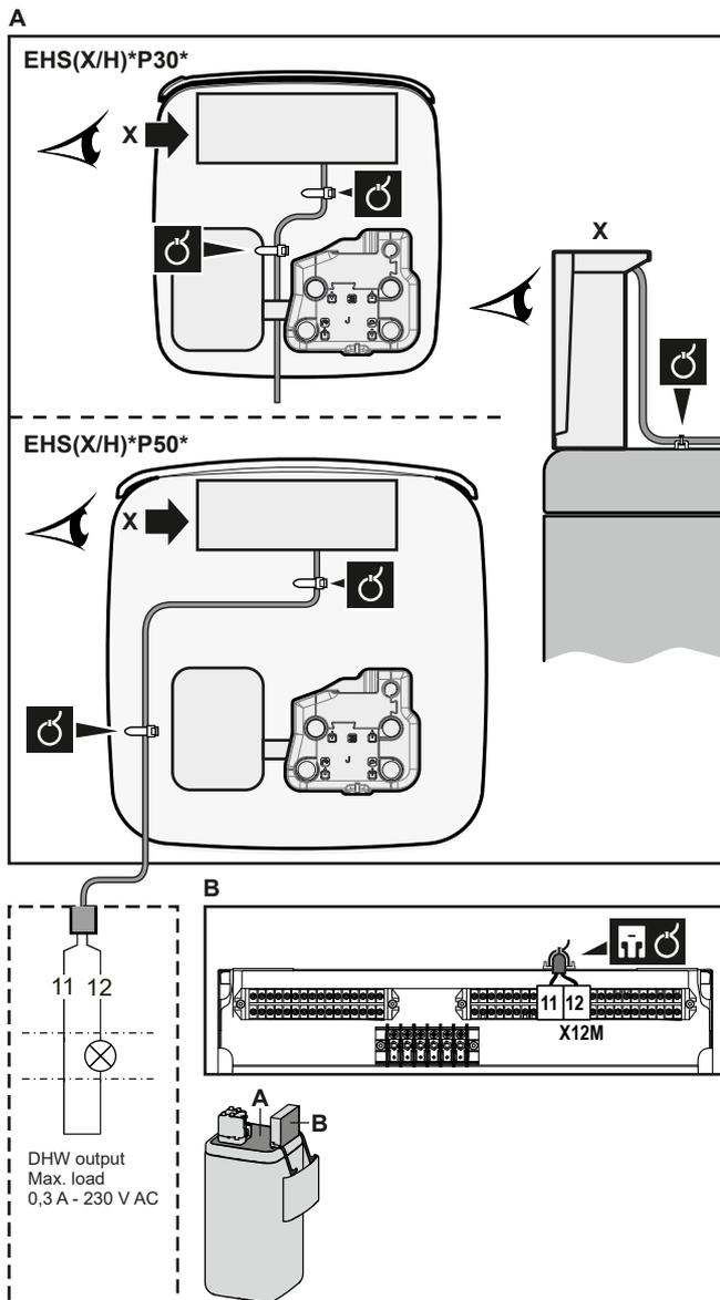
3 Fissare il cavo agli appositi supporti utilizzando le fascette. Per le informazioni generali, vedere "6.3.1 Collegamento del cablaggio elettrico all'unità interna" [p 20].
