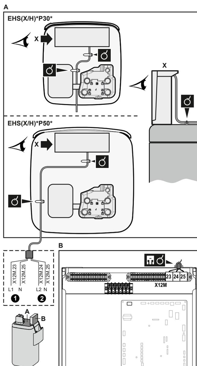
6 Fissare il cavo agli appositi supporti utilizzando le fascette. Per le informazioni generali, vedere ["6.3.1 Collegamento del cablaggio elettrico all'unità interna"](#) [p. 20].
