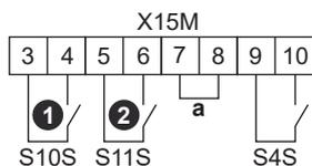
a Ponticello (montato in fabbrica). Se si collega anche il termostato di sicurezza (Q4L), occorre sostituire il ponticello con i cavi del termostato di sicurezza.
