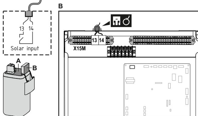
3 Fissare il cavo agli appositi supporti utilizzando le fascette. Per le informazioni generali, vedere "6.3.1 Collegamento del cablaggio elettrico all'unità interna" [▶ 20].
