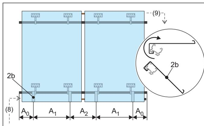
Fig. 4-8 Fase di lavoro 1: allineamento dei ganci di fissaggio (Per la legenda vedere tab. 4-1, per le dimensioni vedere tab. 4-3)
