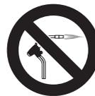
Entfernen Sie die gequetschten Rohre nie durch Löten. Gas- oder Ölreste im Absperrventil können die gequetschten Rohre zerstören.
