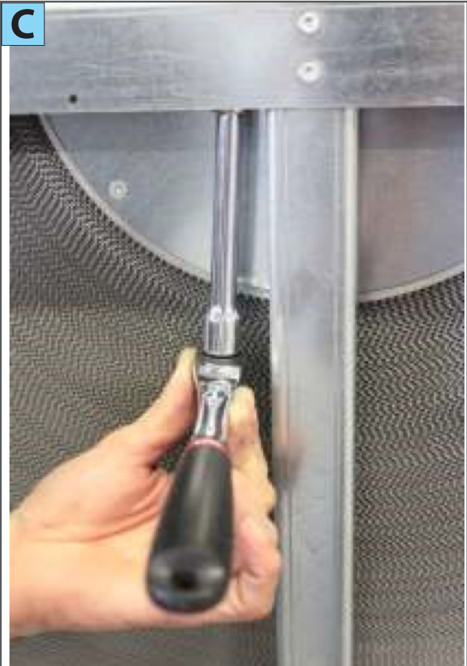
1) Desserrer les 2 vis (photo C)
