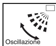
L'immagine della DIREZIONE DEL FLUSSO D'ARIA visualizzata sul display oscilla come illustrato sulla sinistra e la direzione del flusso d'aria varia continuamente. (Impostazione a oscillazione automatica)
