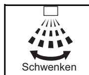
Die Anzeige der **LUFTSTROMRICHTUNG** schwenkt wie links dargestellt und die Luftstromrichtung wechselt kontinuierlich. (Automatische Schwenkeinstellung)
