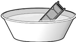
**3-2 Schütteln Sie nach dem Abwischen das verbleibende Wasser ab und lassen Sie den Filter im Schatten trocknen.**
