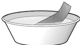
3-2 Schütteln Sie nach dem Abwischen das verbleibende Wasser ab und lassen Sie den Filter im Schatten trocknen.
