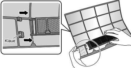
**3. Reinigen oder ersetzen Sie den photokatalytischen Titanium Apatit Luftreinigungsfilter.**
