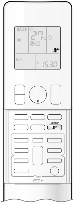
"INTELLIGENTES AUGE" ist der Infrarot-Sensor, der menschliche Bewegungen erkennt. Wenn sich für länger als 20 Minuten niemand im Raum aufhält, wechselt das System automatisch in den Energiesparbetrieb.
