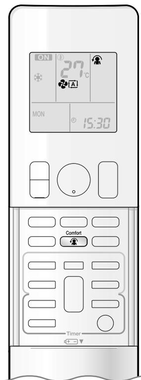
Le courant d'air sera dirigé vers le haut pendant le fonctionnement REFROIDISSEMENT, et vers le bas pendant le fonctionnement CHAUFFAGE, ce qui permet de créer un courant d'air confortable qui n'entre pas en contact direct avec les gens.
