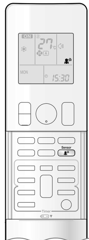
L'“ŒIL INTELLIGENT” est le capteur infrarouge qui détecte les déplacements humains. Si personne ne se trouve dans la salle pendant plus de 20 minutes, le fonctionnement passe automatiquement au fonctionnement économie d'énergie.
