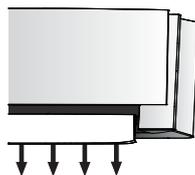
Die Luftstromrichtung wird so angepasst, dass die Luft entlang des Fußbodens verteilt wird.
