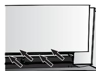
La direzione del flusso d'aria cambia per diffondere l'aria lungo il soffitto.
