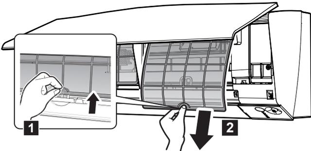
**Classe 40:** Le filtre désodorisant à l'apatite de titane et le filtre à particules d'argent (filtre à ions Ag) DOIVENT être retirés avant de nettoyer le filtre à air.
