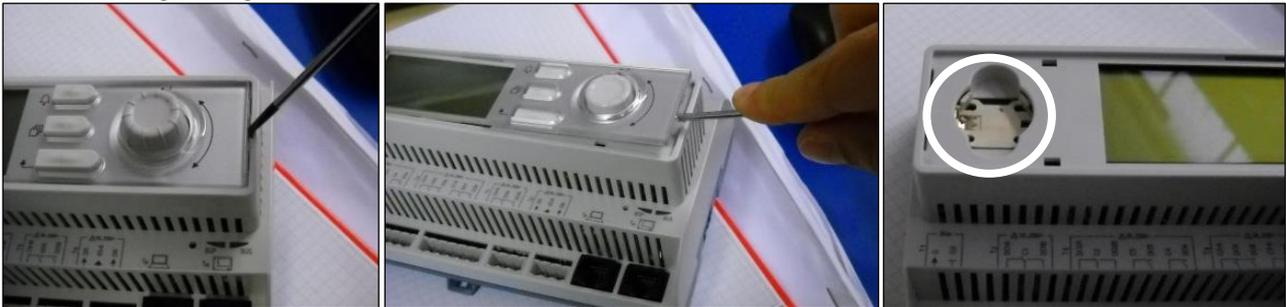
Fare attenzione a non danneggiare la copertura in plastica. Installare la nuova batteria nell'apposito alloggiamento, evidenziato nella figura, prestando attenzione alla polarità indicata nell'alloggiamento stesso.
