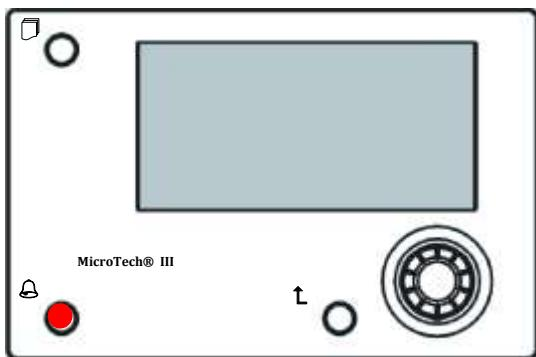
La commande à distance peut être commandée en même temps que l'unité et être livrée en pièce détachée pour une installation optionnelle sur place. Elle peut également être commandée à tout moment après l'expédition d'un refroidisseur et montée et câblée sur place comme expliqué sur la page suivante. Le panneau de commande à distance est alimenté par l'unité et aucune alimentation supplémentaire n'est nécessaire.
