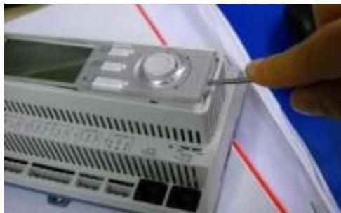
Veiller à ne pas endommager le couvercle. La nouvelle batterie peut être placée dans le support de batterie prévu à cet effet (surligné dans la photo ci-dessous) en respectant les polarités indiquées sur le support.
