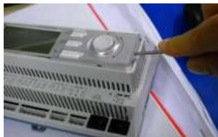
Seien Sie vorsichtig, damit die Kunststoffabdeckung nicht beschädigt wird. Dann die neue Batterie ordnungsgemäß in die Halterung - siehe den markierten Bereich im nachfolgenden Bild - einsetzen und dabei auf die richtige Polarität achten, so wie sie in der Halterung gekennzeichnet ist.
