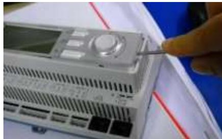
Fare attenzione a non danneggiare la copertura in plastica. Installare la nuova batteria nell'apposito alloggiamento, mostrata nella seguente figura, prestando attenzione alla polarità.
