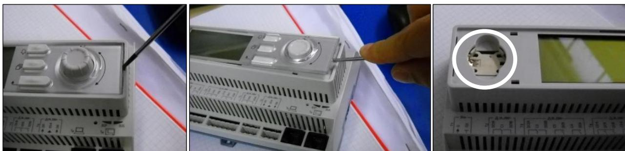
Fare attenzione a non danneggiare la copertura in plastica. Installare la nuova batteria nell'apposito alloggiamento, evidenziato nella figura, prestando attenzione alla polarità indicata nell'alloggiamento stesso.
