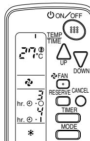
Wenn der Timer programmiert ist, die Anlage nach 3 Stunden zu stoppen und nach 4 Stunden zu starten, stoppt die Anlage nach 3 Stunden und startet anschließend 1 Stunde später erneut.
