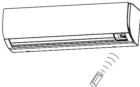
**2 kurze Pieptöne vom Empfänger zeigen, dass die Übertragung ordnungsgemäß durchgeführt wurde.**
