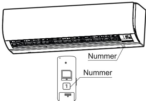
Bedienen Sie das Innengerät mit der Fernbedienung mit derselben Nummer. Das von einer Fernbedienung mit einer anderen Nummer eingehende Signal kann nicht akzeptiert werden. (Wenn die Nummer nicht angegeben ist, wird diese als "1" angesehen)
