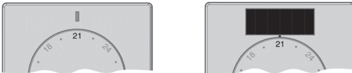
Fig. 45: Exemple : température ambiante réglée sur 21 °C
