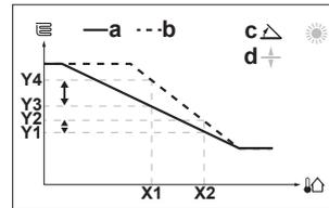
**Décalage.** Lorsque le décalage est modifié, la nouvelle température préférée à X1 est également supérieure à la température préférée à X2.
